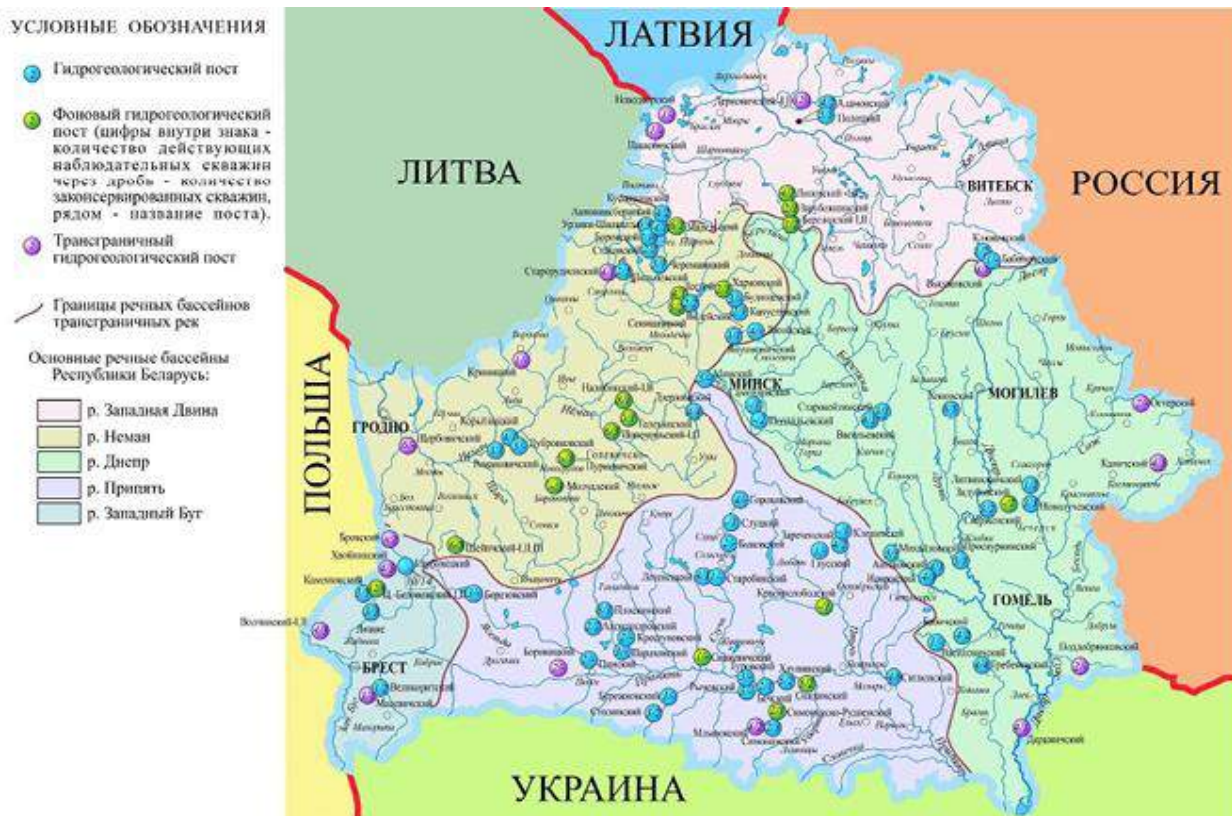
Рисунок 3.1.12 – Карта-схема действующих пунктов наблюдения за уровнем режимом и состоянием подземных вод (по состоянию на 01.01.2022 г.) [18]
